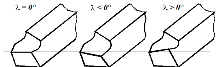
Рис. 7. – Розташування кута нахилу головної ріжучої кромки відповідно вершини інструменту.
