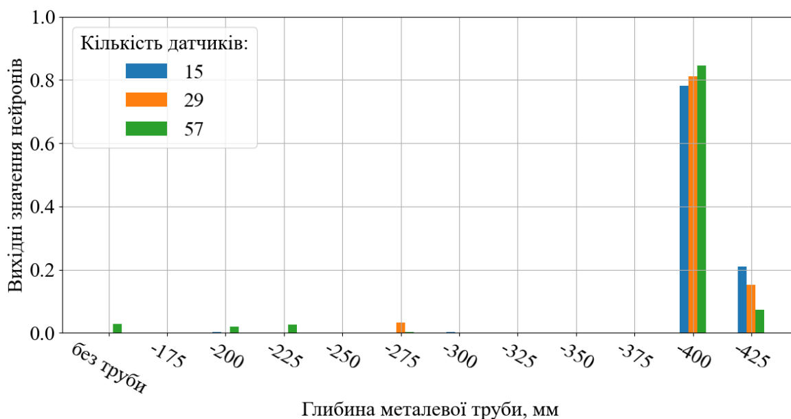
Рис. 3.25. Результат розпізнавання металевої труби на глибині 410 мм штучною нейронною мережею з використанням прийнятих часових залежностей у якості вхідних даних
