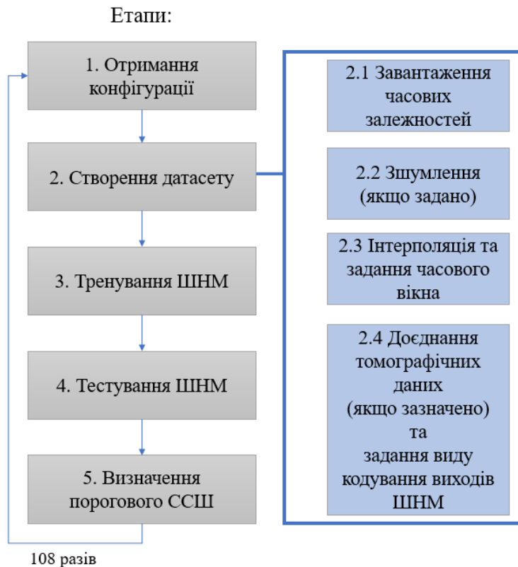
Рис. 3.43. Алгоритм сіткового пошуку для виявлення найбільш шумостійкої комбінації параметрів модельованої задачі
