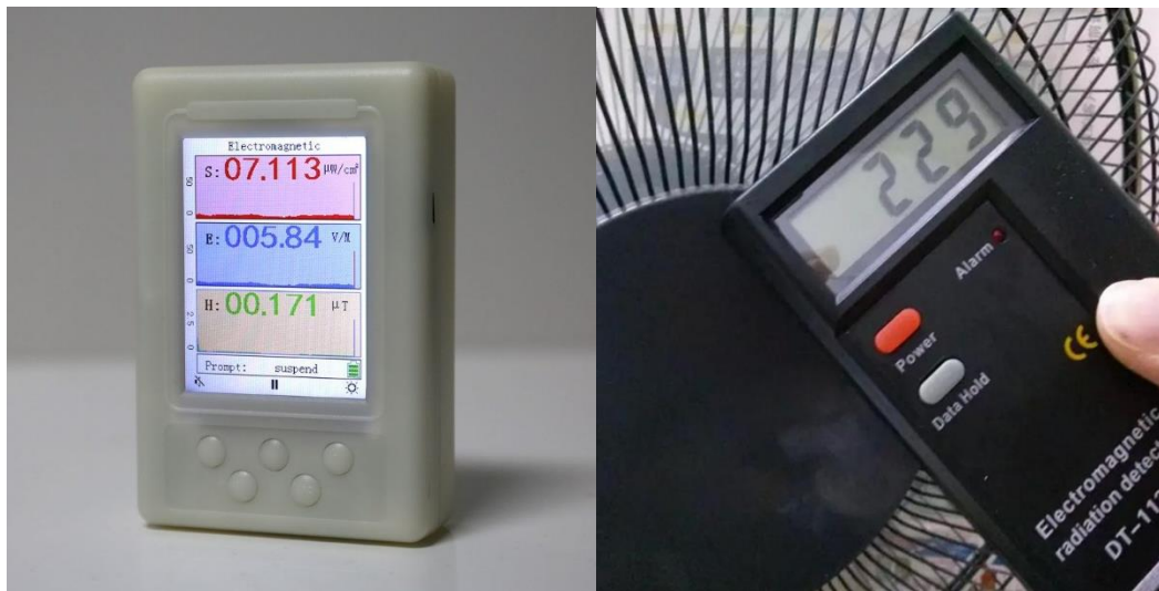
Рис. 2.1 – Тестери електромагнітних полів Kailishen BR-9A і DT-113
