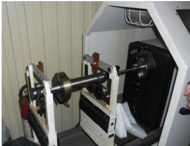
Рисунок 2.11 – Спеціальний балансувальний верстат фірми СЕМВ для попереднього балансування черв'ячних кіл разом із планшайбою
