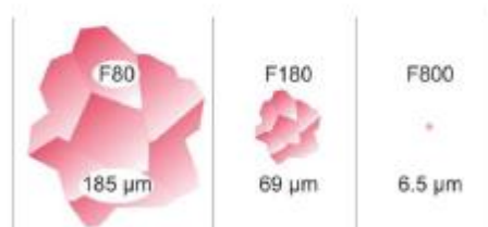
Рисунок 3.2 – Порівняння розмірів зерен шліфувальної та полірувальної частин абразивного кола
