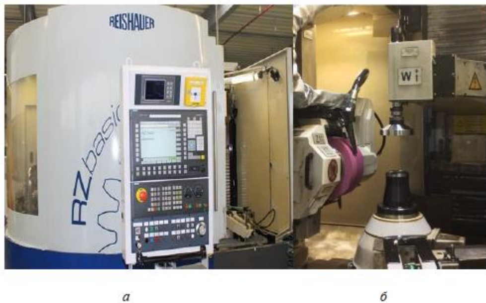
Рисунок 2.8 – верстат Reishauer RZ basic: а – загальний вигляд; б – робоча зона
