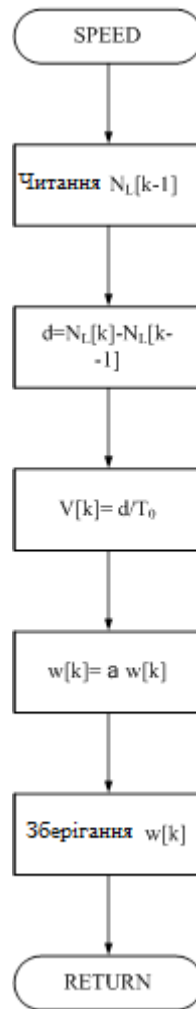
Рисунок 4.24 – Блок - схема алгоритму обчислення швидкості обертання двигуна
