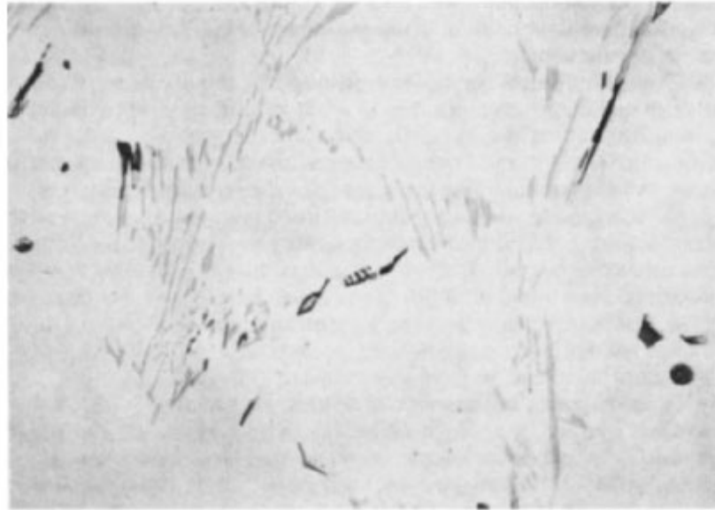
Рис.1.7. Мікроскопічне зображення розподілу фаз (\text{Mn,Fe})\text{Al}_6 (світлі області) та (\text{Fe,Mn})_3\text{SiAl}_{12} (темні області) у дендритних проміжках сплаву 3003 [4]
