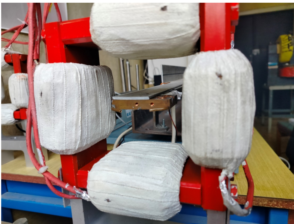
Рисунок 4.1 – Вид коректора з матрицею на дюралевій штанзі по центру апертури
