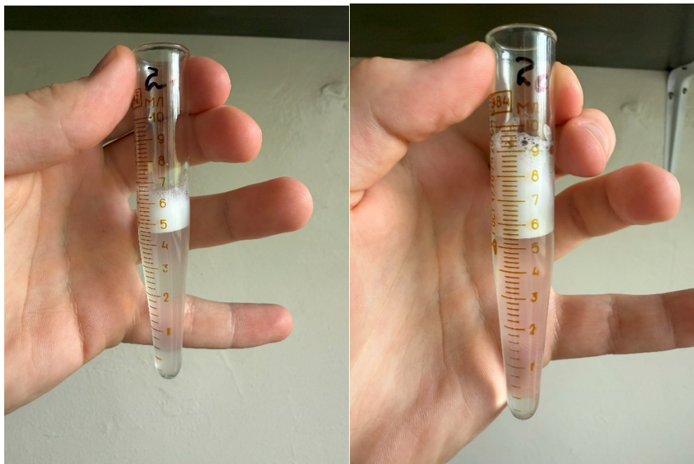
Рис. 3.5. Результат аналізу піноусадження для розчинів 2 та 2с
