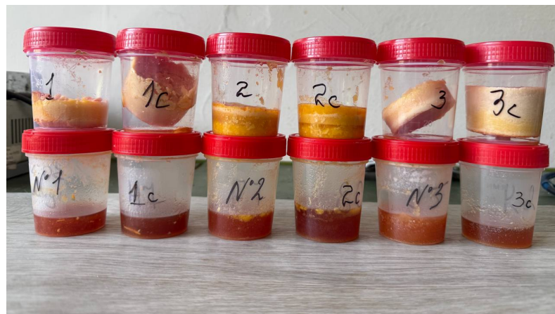
Рис. 2.8. Мило відокремлене від залишків продуктів реакції.
