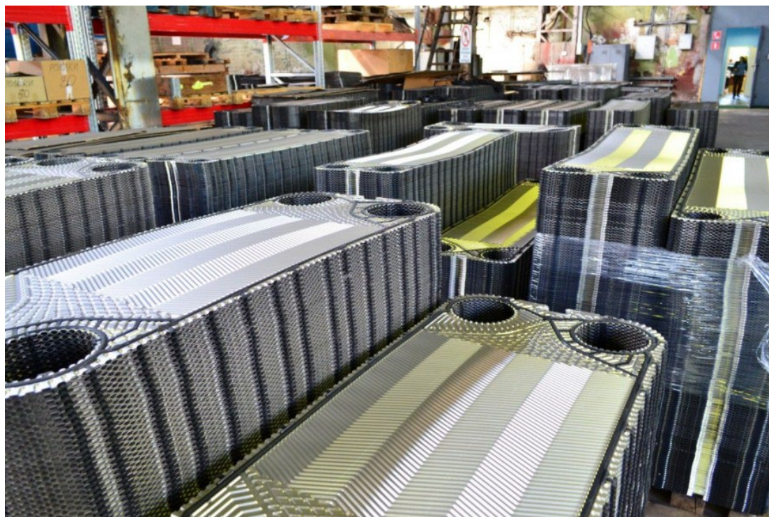
Рисунок 2.4 - Готовий виріб (пластина для теплообмінника)
