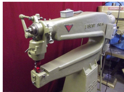
Рисунок 2.5 - Ножиці вібраційні для розкрою листового матеріалу
