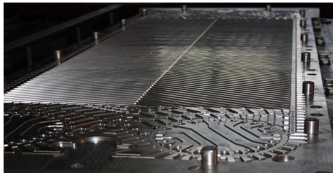
Нижня частина штампа (Матеріал матриці - 12ХМФ. Твердість – 57...60 HRC.)
