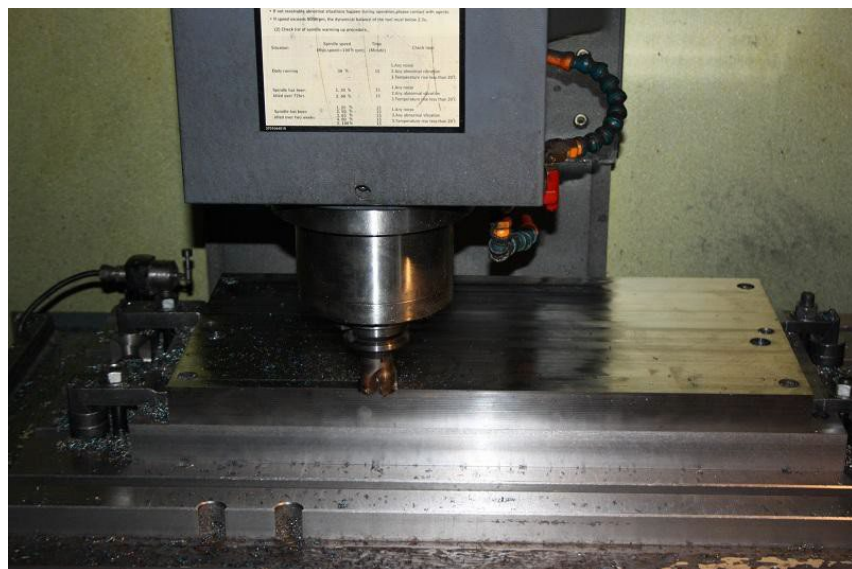
Рисунок 2.10 – Фрезерування загартованої заготовки.
