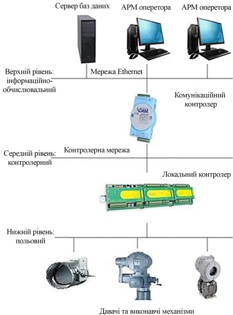
Рисунок 3.1 – Трирівнева система АС
