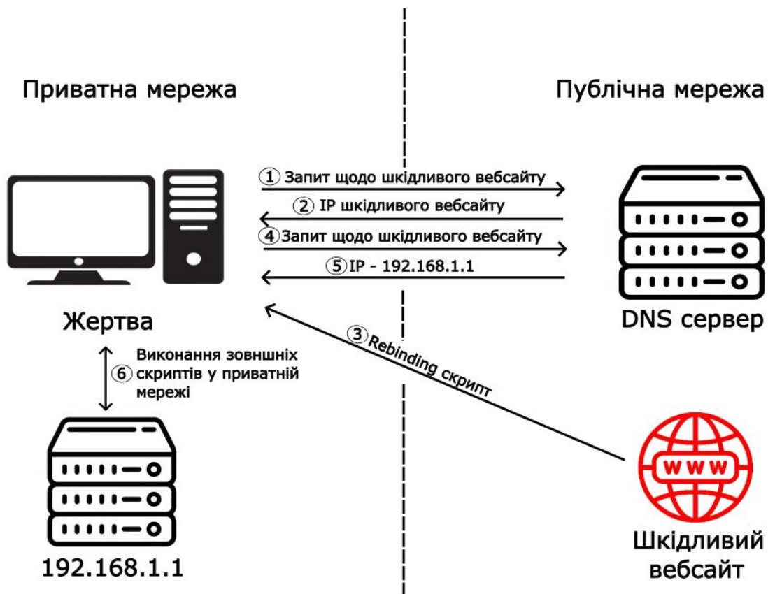
Рисунок 1.4 - Схема реалізації атаки DNS Rebinding (за даними [11])
