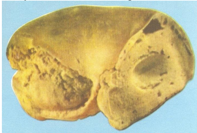
Рис. 1.14 Дефект — бічні випливи і тріщини
