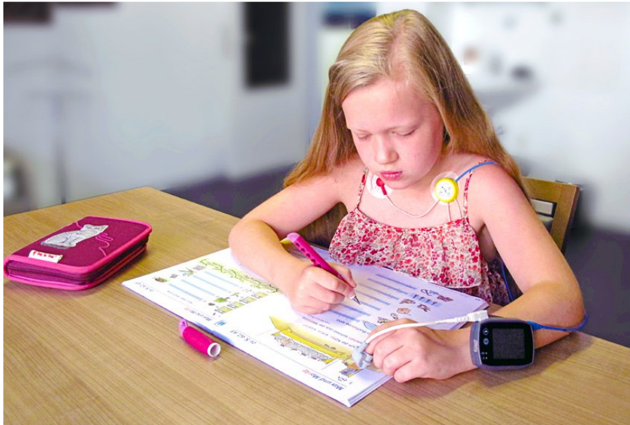
Рис. 8. Застосування поліграфу SOMNOtouch NIBP для добового моніторингу АТ [8]
