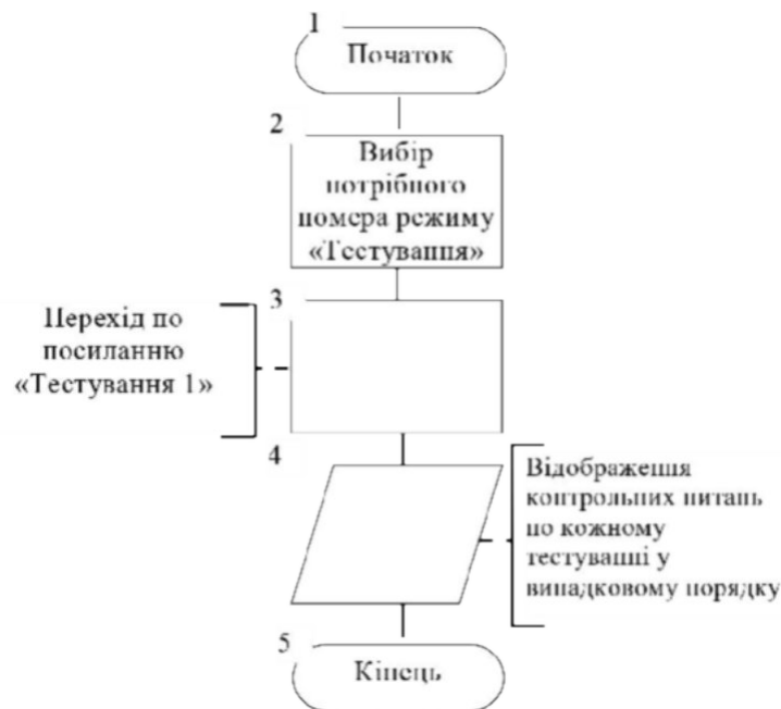
Рис. 2.19. Схема алгоритму вибору намера тестування
