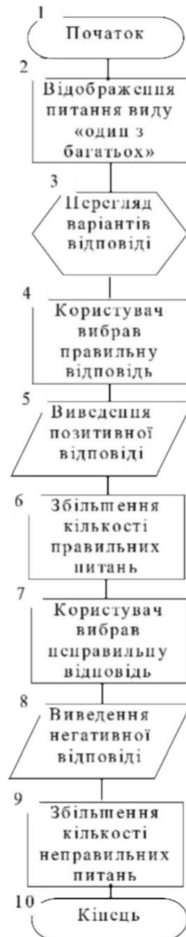
Рис. 2.21. Схема алгоритму аналізу відповіді на питання тестування
