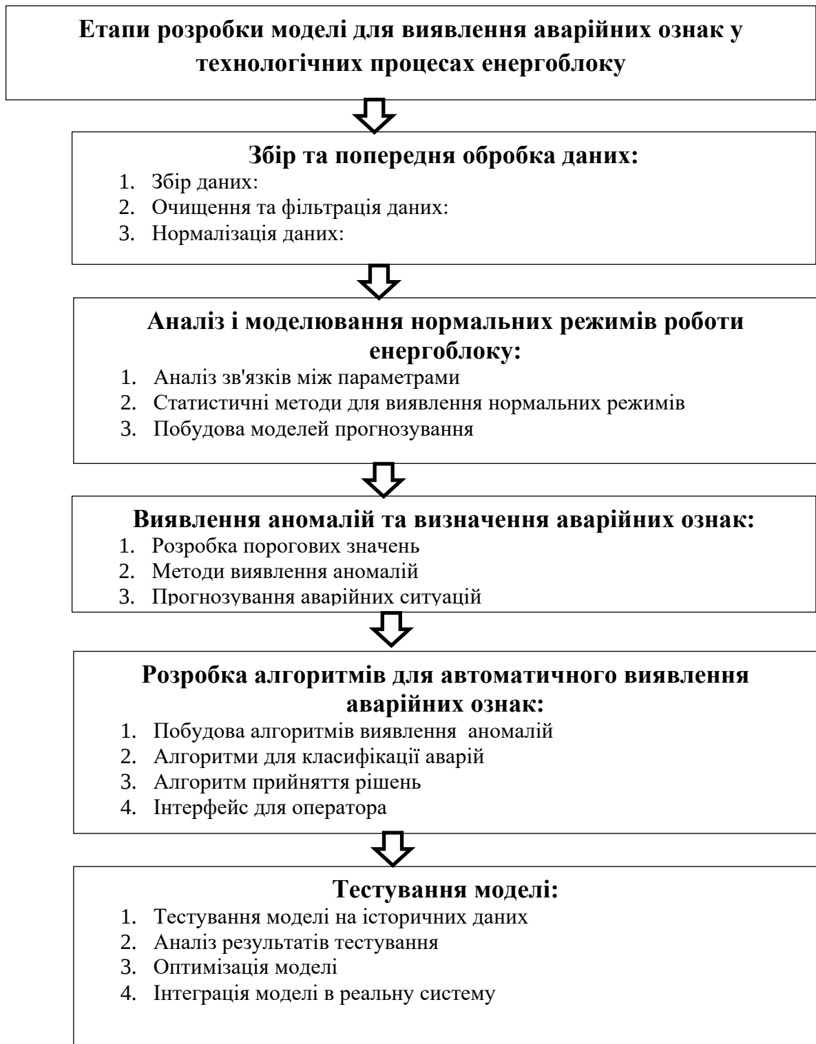
Рис. 3.1 – Розробка етапів моделі для виявлення аварійних ознак у технологічних процесах енергоблоку
