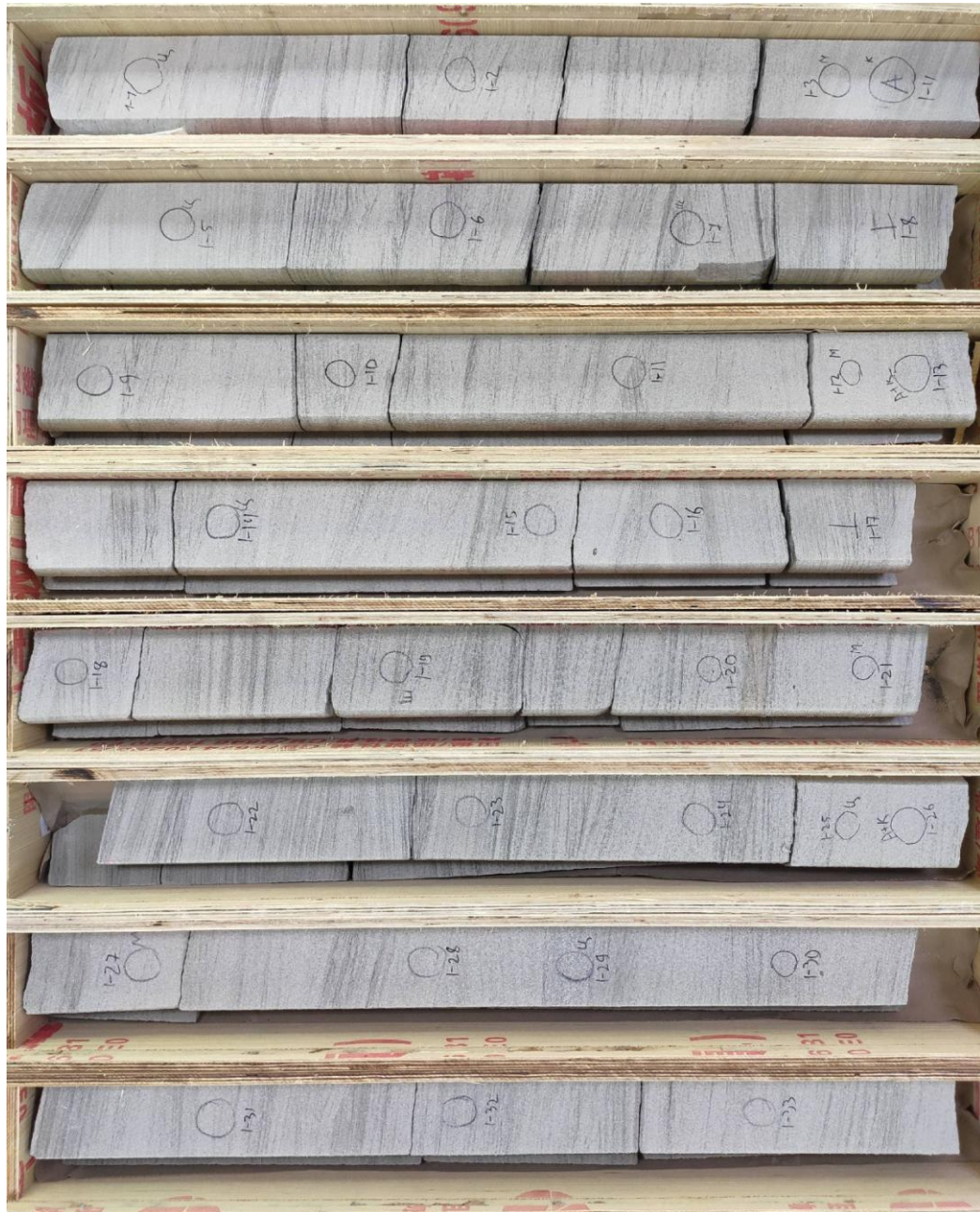
Рисунок 3.1.1 – Підготовлений до подальшої роботи керовий матеріал на прикладі свердловини №14 Моспанівського родовища, керн 1
