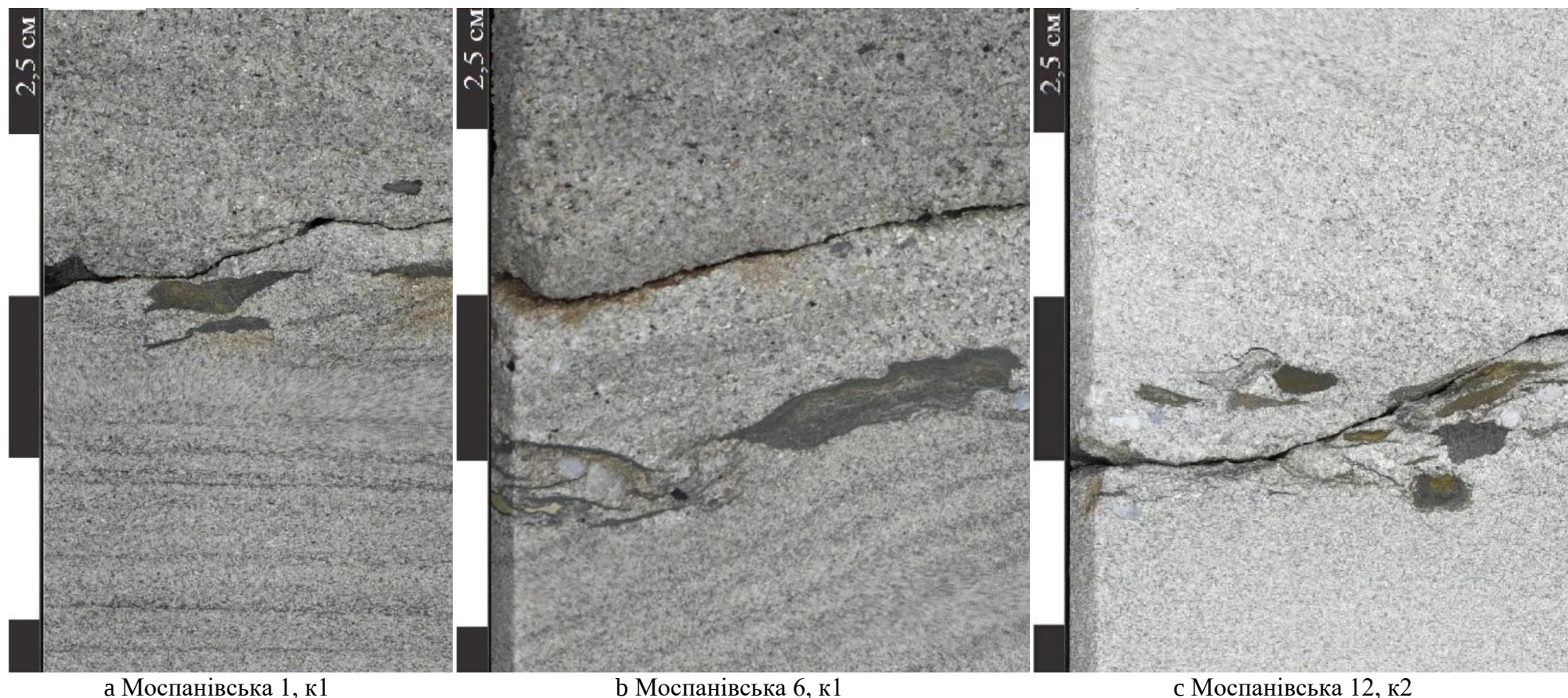
Рисунок 4.1.2 – а – внутрішньо-формаційна брекчія на контакті прошарків різного гранулометричного складу; б – ерозійний контакт прошарків крупно- (зверху) та дрібнозернистого (знизу) пісковика, на контакті – внутрішньоформаційна брекчія (grip-clast) та лінзоподібні включення залізного карбонату; с – Внутрішньо-формаційна брекчія на контакті прошарків різного гранулометричного складу
