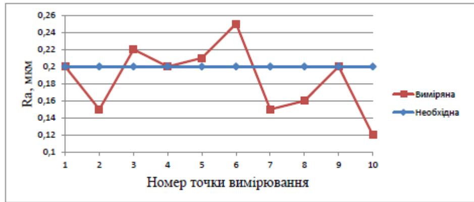
Рисунок 2.2 – Шорсткість складнопрофільної поверхні прес-форми
