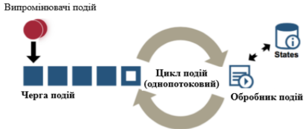
Рисунок 5. Модель обробки Node.js
