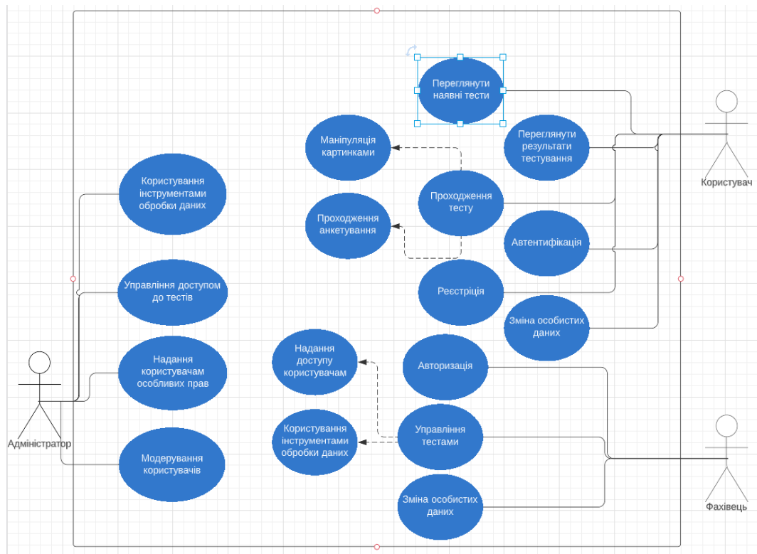
Рисунок 17. Діаграма варіантів використання (UseCase diagram) “Комп'ютерної модель обробки великих обсягів даних ”
