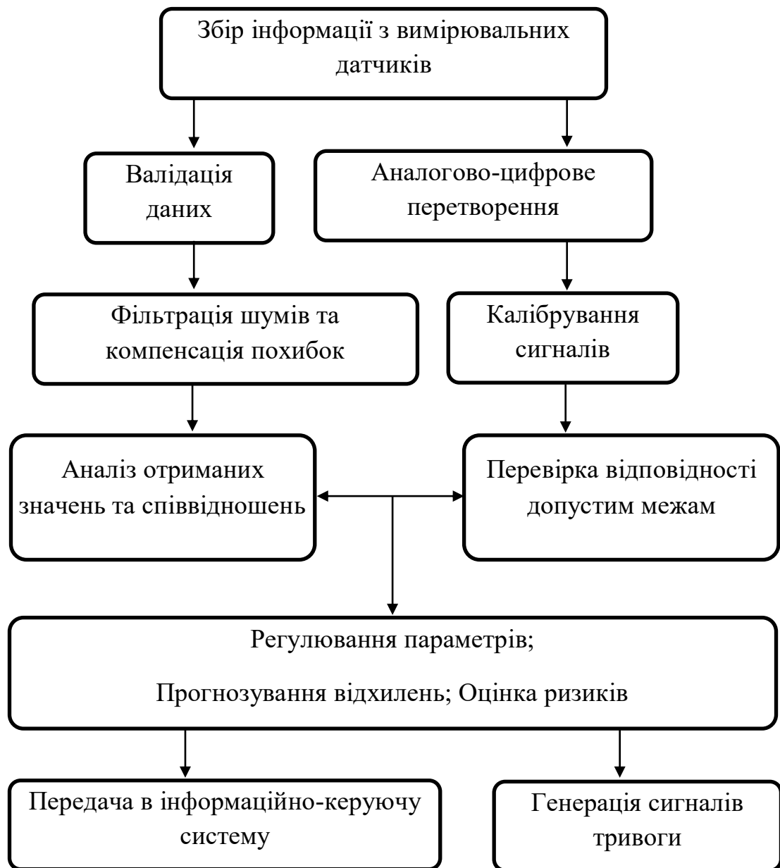
Рисунок 2.1 – Блок-схема алгоритму обробки інформації в інформаційно-керуючій системі ПТК АСУ ТП енергоблоку АЕС
