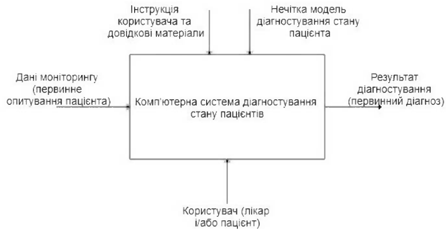
Рис. 2.9 – IDEF0-діаграма моделі комп'ютерної системи діагностування пацієнтів
