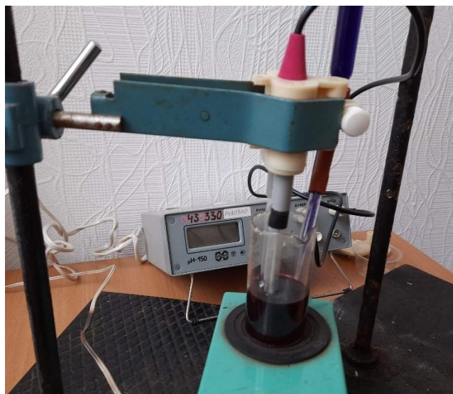
Рис. 2.15. Установка для потенціометричного титрування
