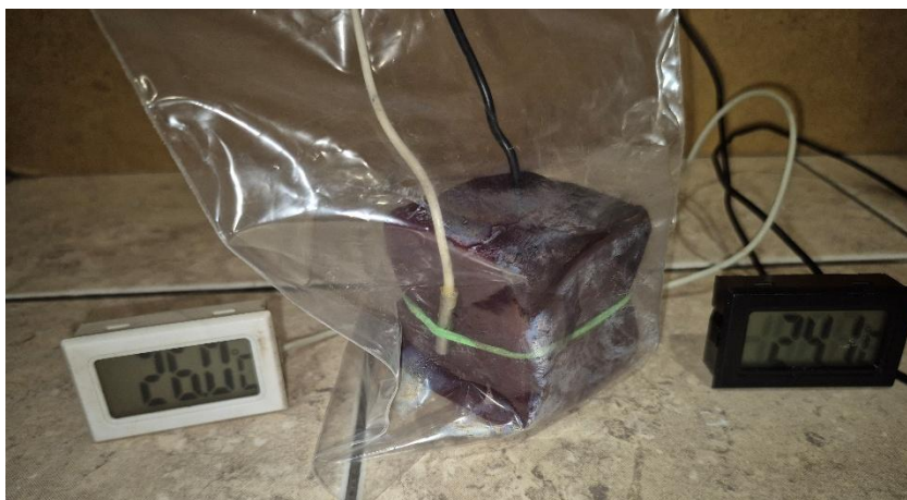
Рис. 2.5. Вимірювання температури на поверхні і в глибині зразку
