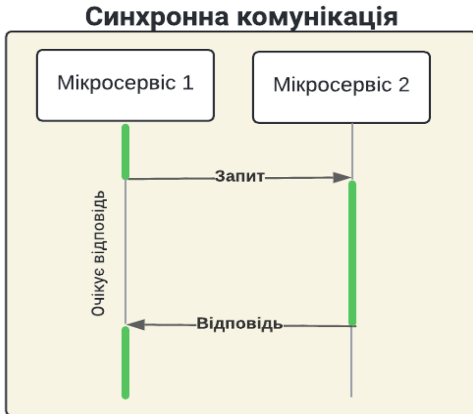
Рисунок 1.3 – Приклад взаємодії мікросервісів з використанням синхронної комунікації
