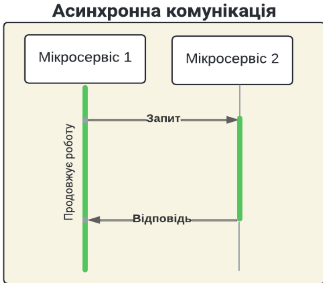
Рисунок 1.4 – Приклад взаємодії мікросервісів з використанням асинхронної комунікації
