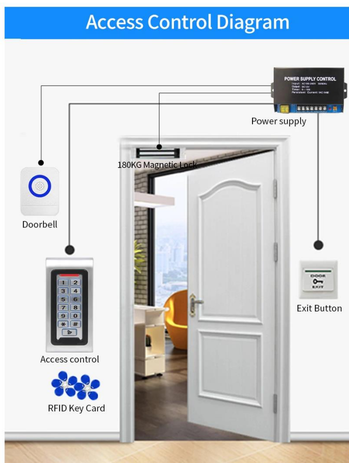
Рисунок 4.3 – Діаграма підключення клавіатури доступу в систему
