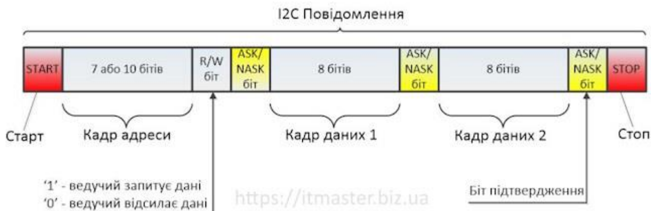
Рисунок 1.14 – Приклад повідомлення в протоколі I2C
