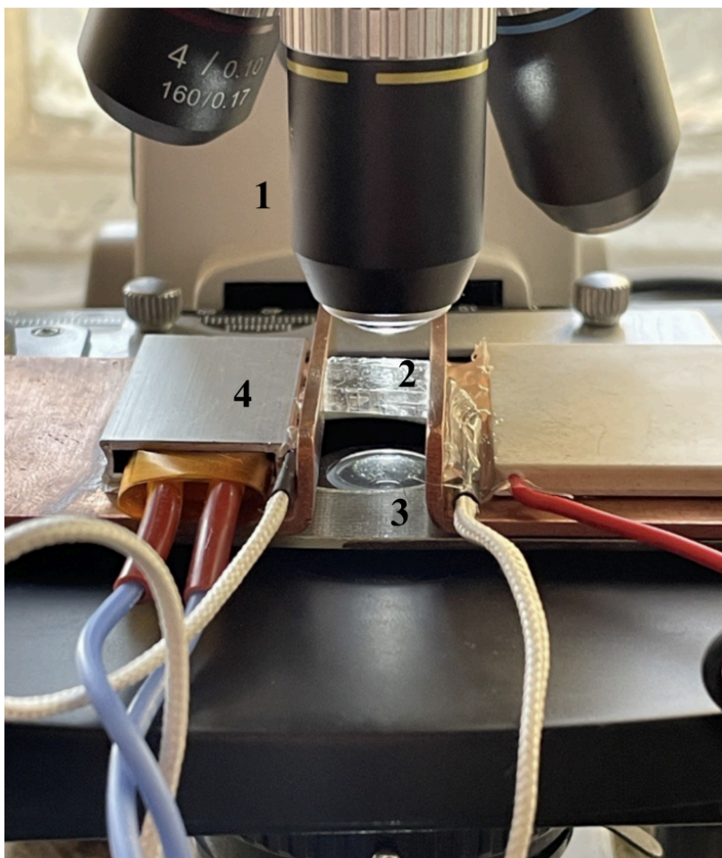
Рис. 3.2. Схема установки для оптично-мікроскопічного спостереження за морфологією ансамблів пор та рідких включень в оптично-прозорих кристалах: 1) об'єктив мікроскопа, 2) кристалічний зразок, 3) предметний стіл мікроскопа, 4) тримач зразка.
