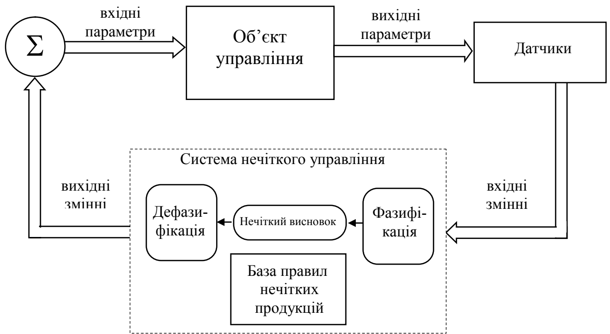
Рисунок 1.3 – Архітектура компонентів процесу нечіткого управління
