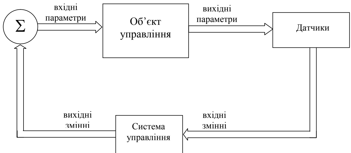
Рисунок 1.2 – Архітектура компонентів процесу управління із зворотним зв'язком
