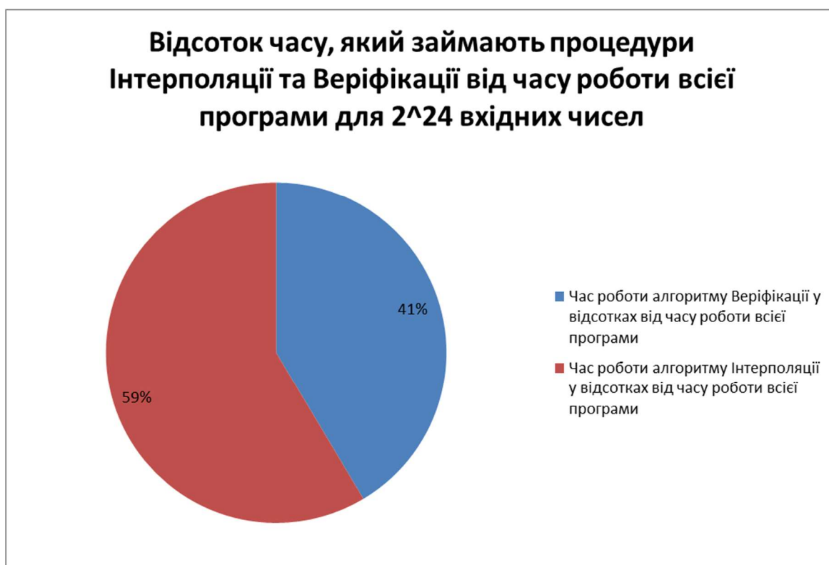
Рисунок 3.13 – Відсоток часу, який займають процедури Інтерполяції та Верифікації від часу роботи всієї програми для 2^{24} вхідних чисел (максимальної кількості) при використанні методу ШЗПФ для Інтерполяції
