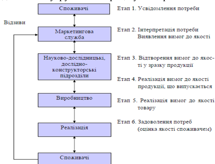
Рис. 2.6 Схема укрупненого процесу «створення якості» продукції
