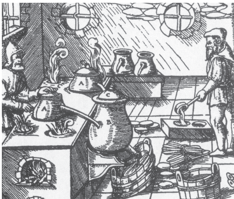
Алхимическая лаборатория, где извлекают серу из ее соединений с металлами. Гравюра из книги Г. Агриколы
