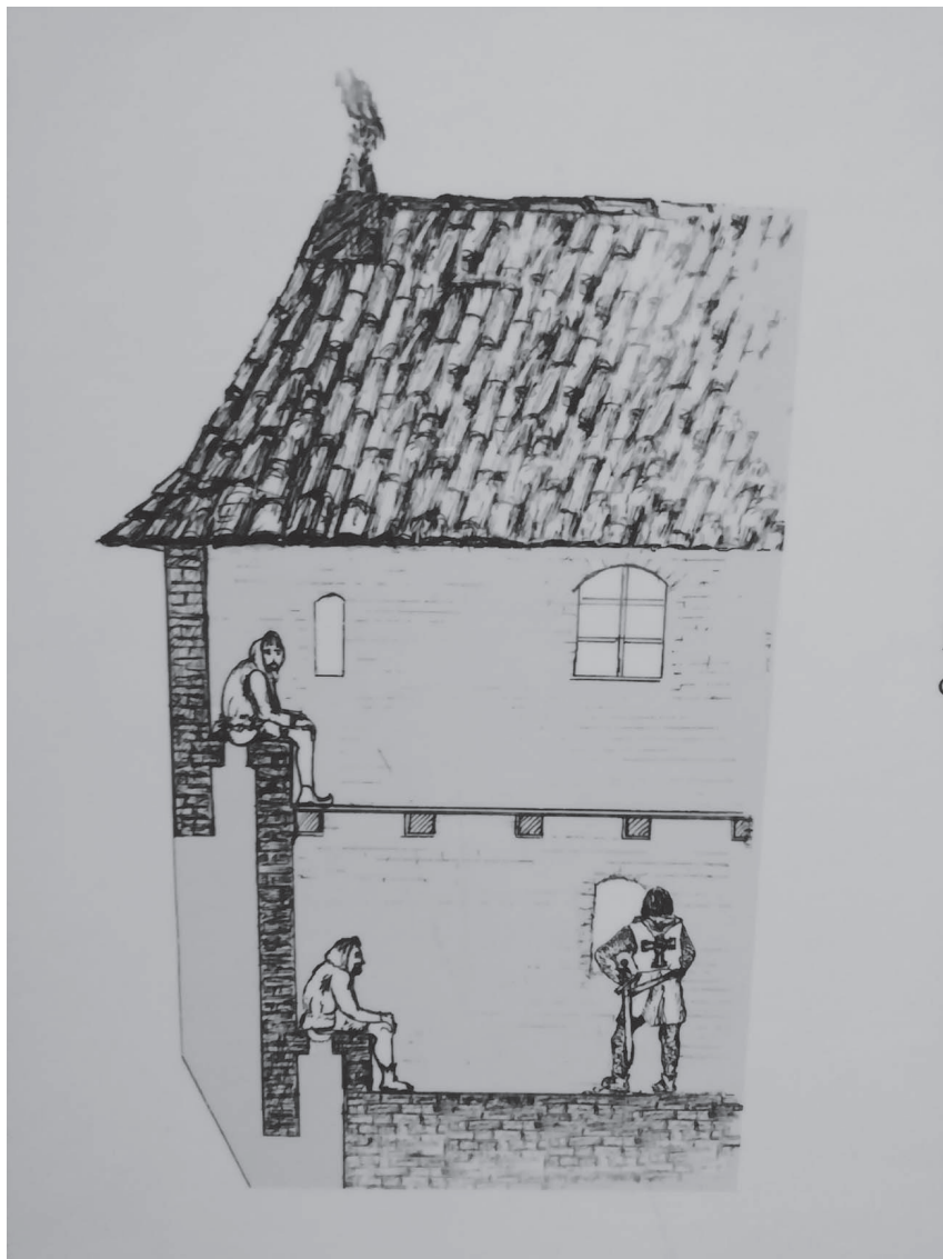
Система сухого туалета в замке Мальборк, Польша. Фото А.А. Опарина
