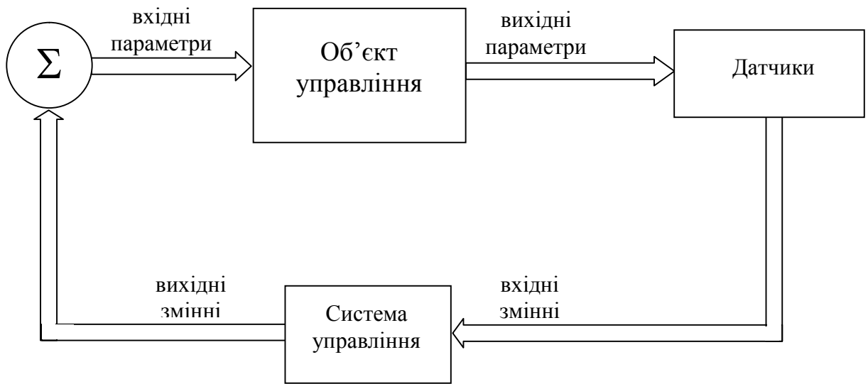
Рисунок 1.1 – Узагальнена схема процесу керування зі зворотним зв'язком
