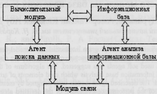
Рис. 1. Структурная схема узла распределенной вычислительной системы
