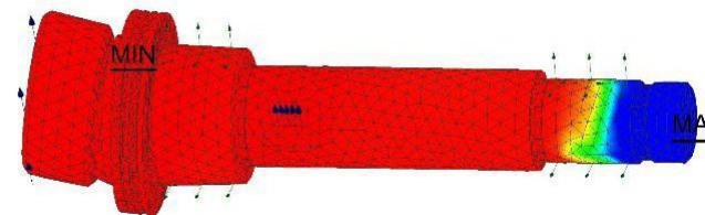
Кінцево-елементна сітка. Параметри і результати розбиття
