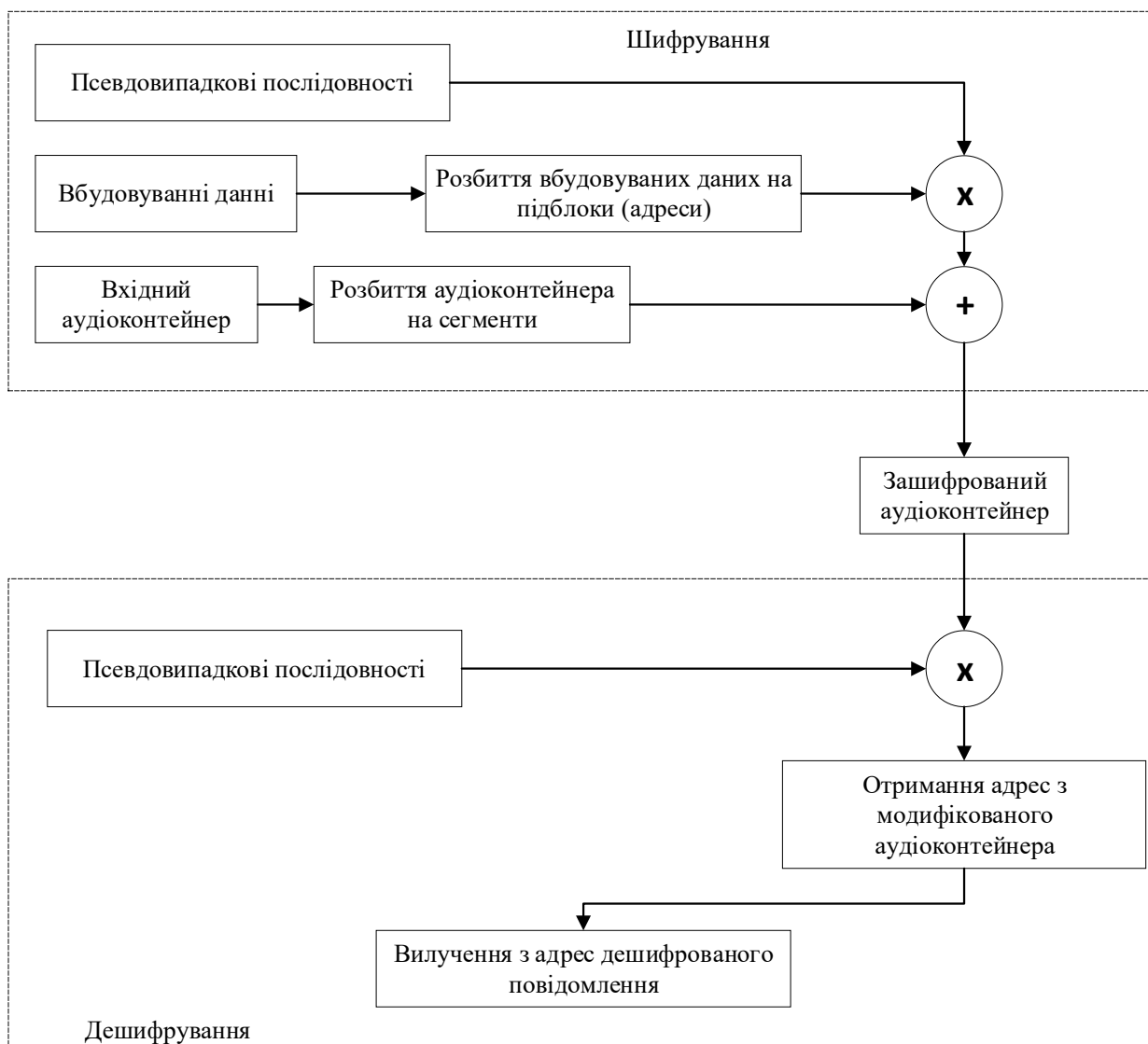
Рисунок 2.3 – Алгоритм вбудовування повідомлення методом адресації
