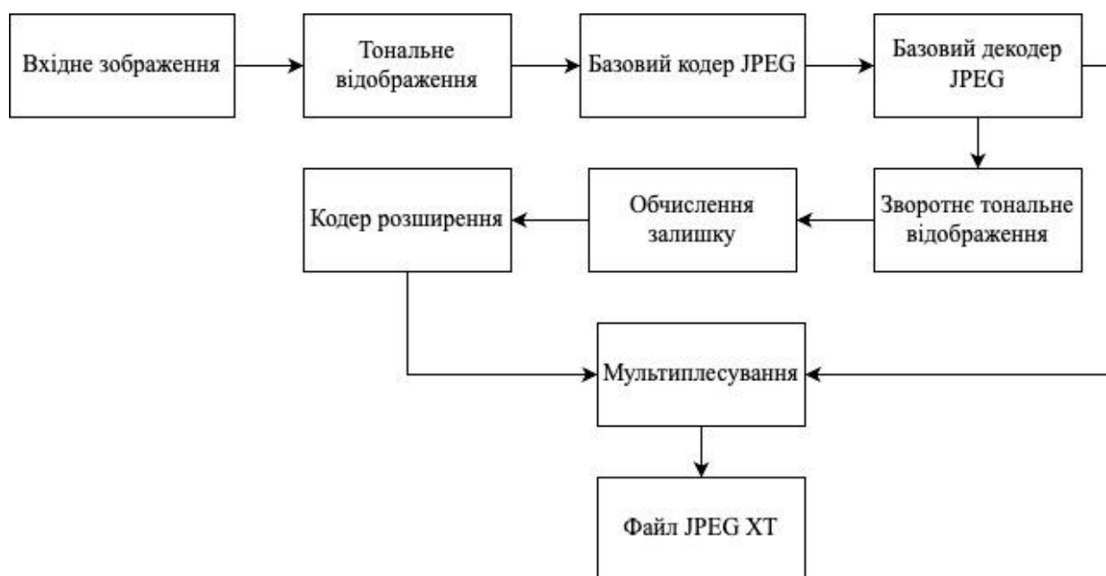
Рисунок 1.7 – Схема основних етапів кодування JPEG XT
