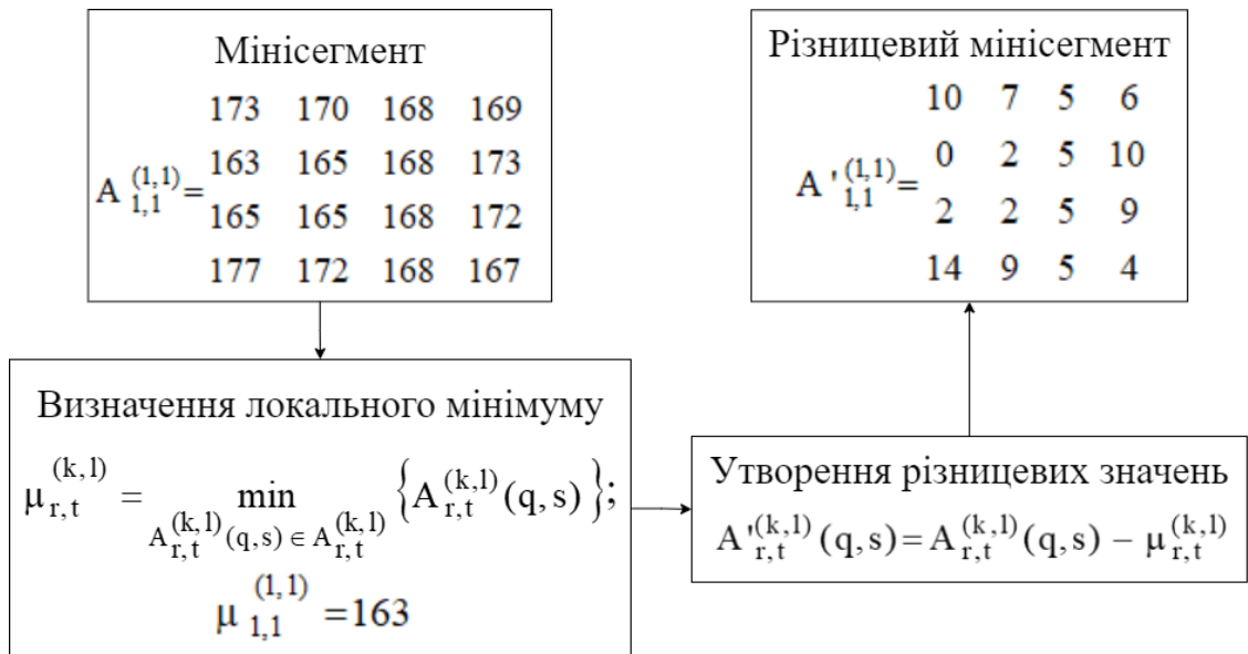
Рисунок 3.3 – Схема різницевого кодування мінісегменту
