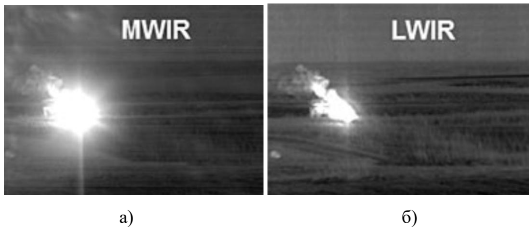
Рисунок 1.6 – Порівняння ІЧ кадрів у діапазонах MWIR та LWIR: а) зображення отримане з ІЧ MWIR камери, б) зображення отримане з ІЧ LWIR камери
