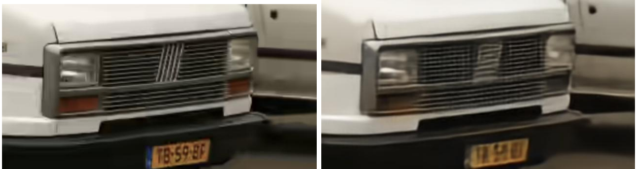
Рисунок 1.13 – Приклад галюцинації JPEG AI спричинений регулярною структурою радіаторної сітки автомобіля: а) оригінальне зображення, б) закодоване та декодоване зображення із використанням JPEG AI
