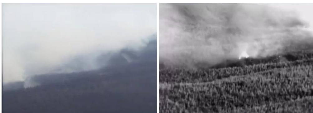
Рисунок 1.4 – Порівняння кадрів у видимому діапазоні та SWIR: а) зображення отримане з оптичної камери, б) зображення отримане з ІЧ SWIR камери
