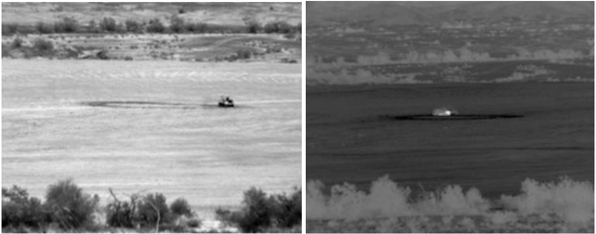
Рисунок 1.5 – Порівняння кадрів у видимому діапазоні та MWIR: а) зображення отримане з оптичної камери, б) зображення отримане з ІЧ MWIR камери
