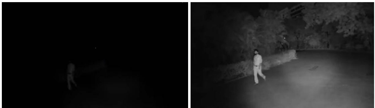
Рисунок 1.3 – Порівняння кадрів у видимому діапазоні та NIR: а) зображення отримане з оптичної камери, б) зображення отримане з ІЧ NIR камери See3CAM_CU27
