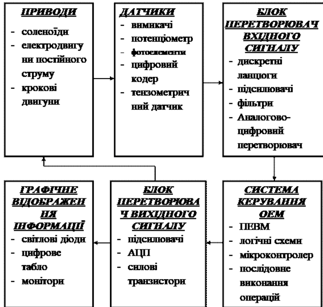
Рисунок 13.3 - Ієрархічна структура мехатронної системи
