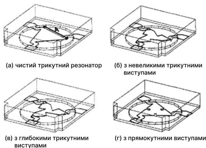
Рисунок 2.2 Різновиди трикутних конфігурацій циркуляторів.
