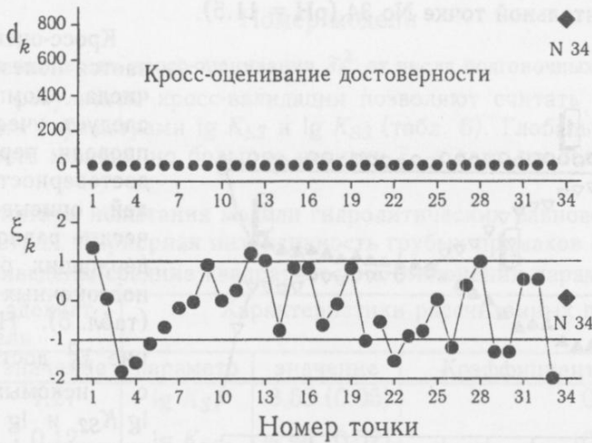
Рис. 9. Невязки кросс-оценивания d_k и локальные критерии адекватности \xi_k для модели гидролитических равновесий Sb(III)
