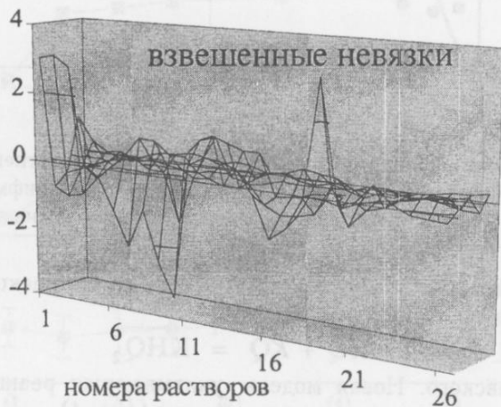
Рис. 2. Локальные критерии адекватности для модели равновесий в растворах м-аминобензойной кислоты. Расчет по программе CLINP 2.1 для \delta = 20\%
