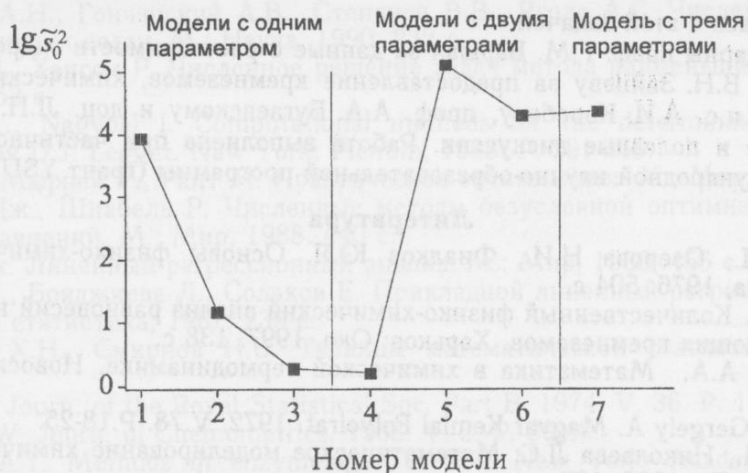
Рис. 12. Зависимость дисперсии кросс-оценки \tilde{s}_0^2 от числа подгоночных параметров модели
