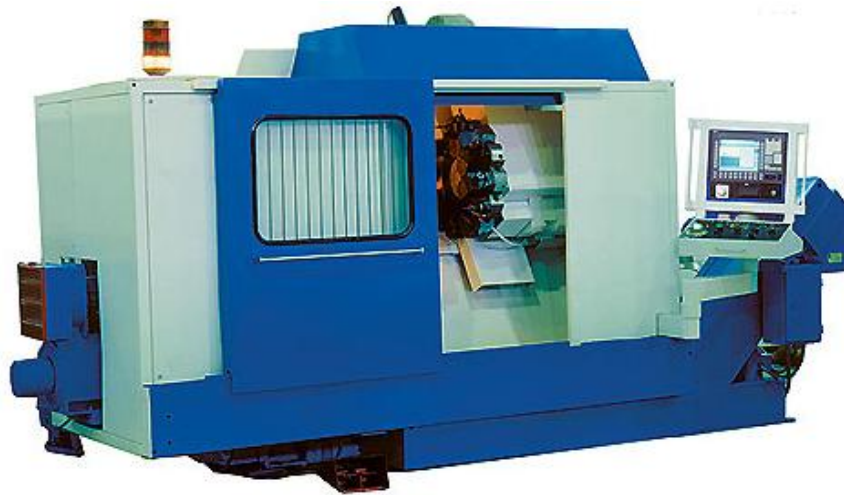
Рисунок 6.2 – Спеціальний токарно-багатоцільовий патронний напівавтомат IPT180ПМФ4
