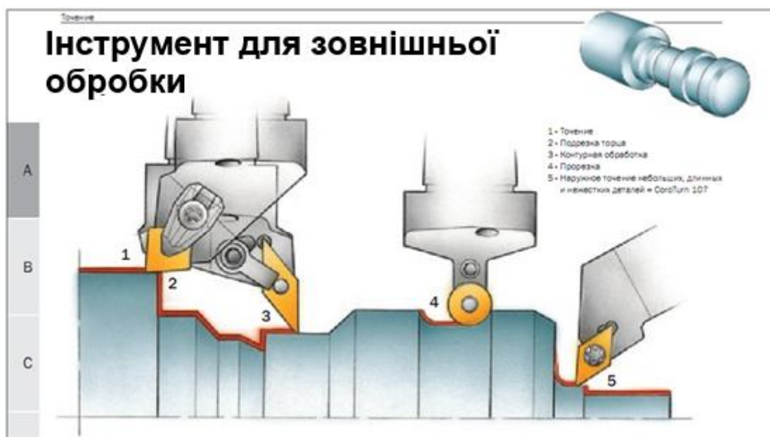
Рисунок 5.5 – Типы инструментов для внешней обработки
