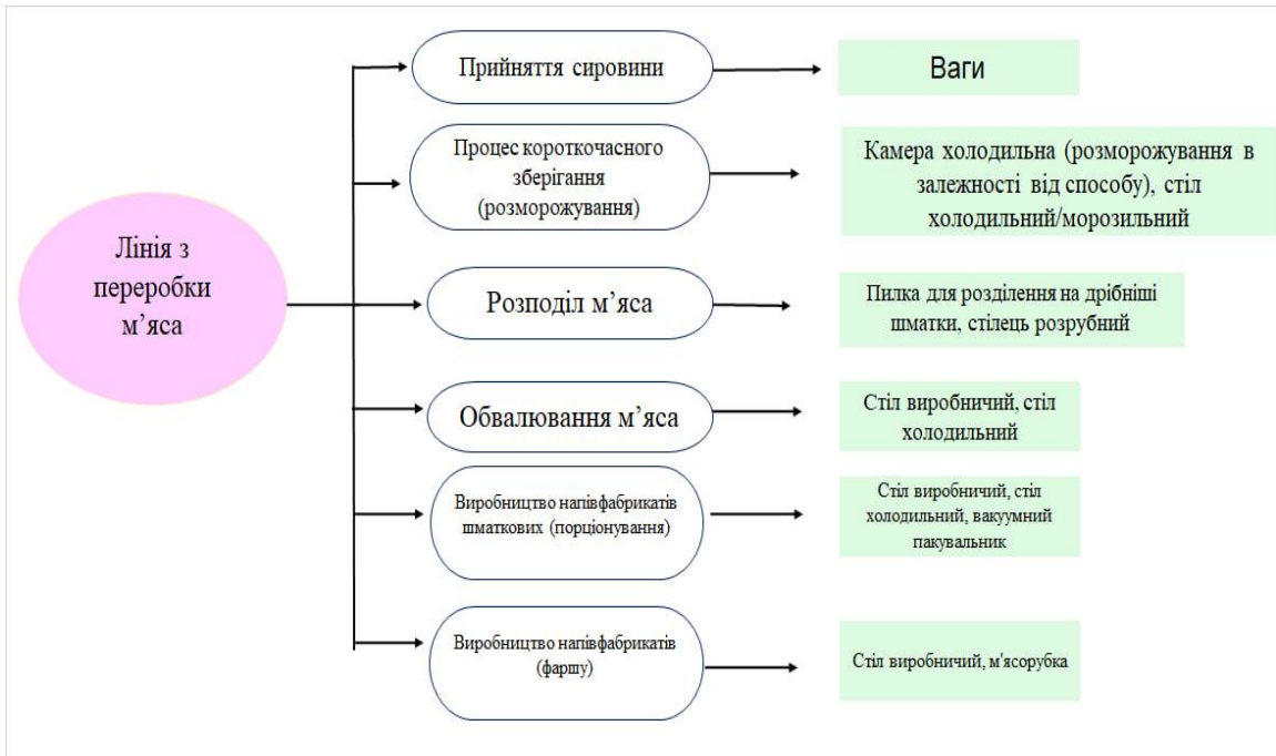
Рис. 2.13 Виробничий процес заготівельного цеху (м'ясний цех)
