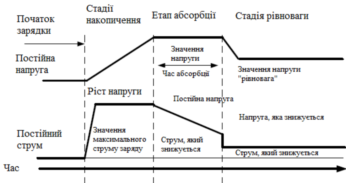
Рисунок 2.5 – Стадії заряду акумуляторів
