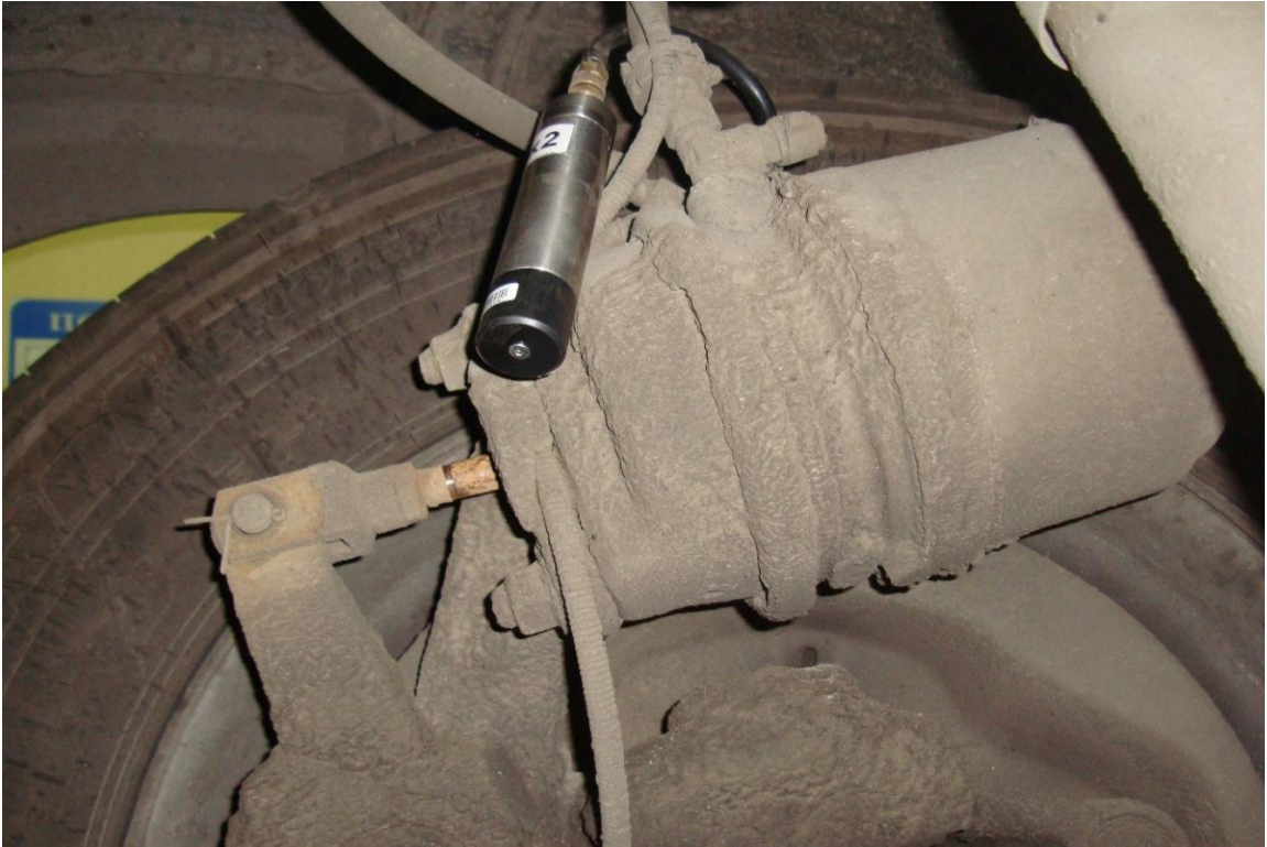
Рисунок 3.13 - Пневматичний радіодатчик тиску Rx2
