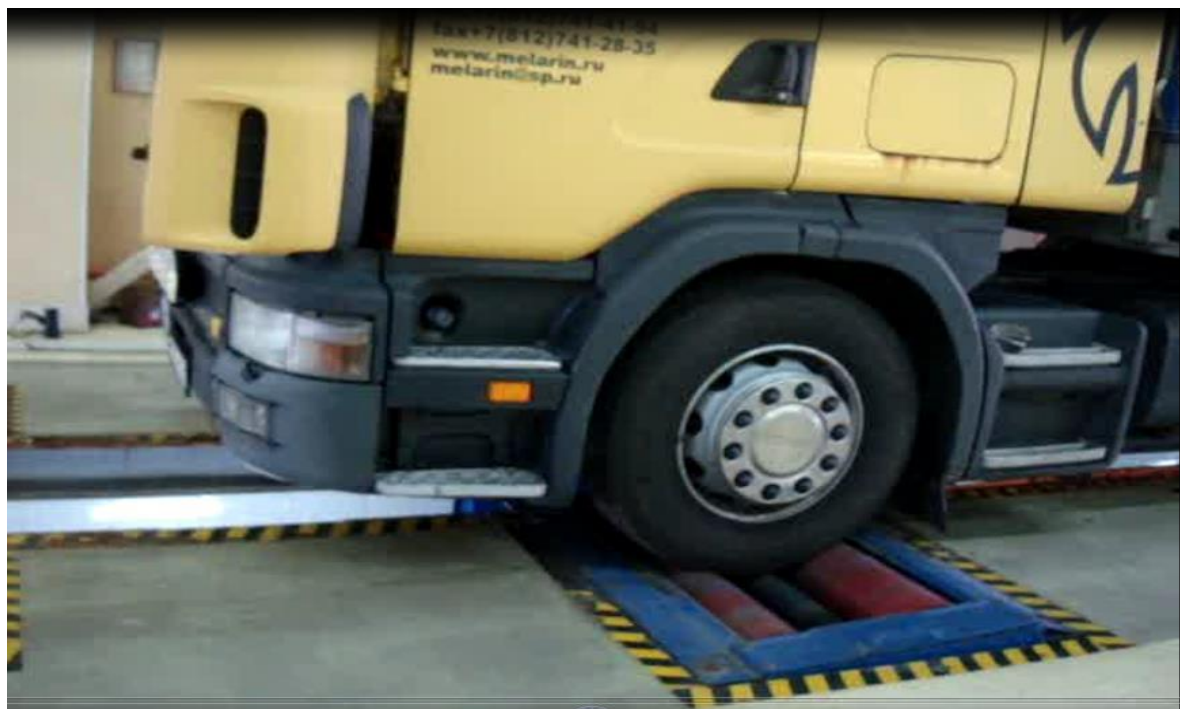
Рисунок 3.2 - Установка передньої осі тягача Scania R 114 LA 4x2 LA 340 SLA на силовому роликовому гальмовому стенді IW 7 Eurosystem
