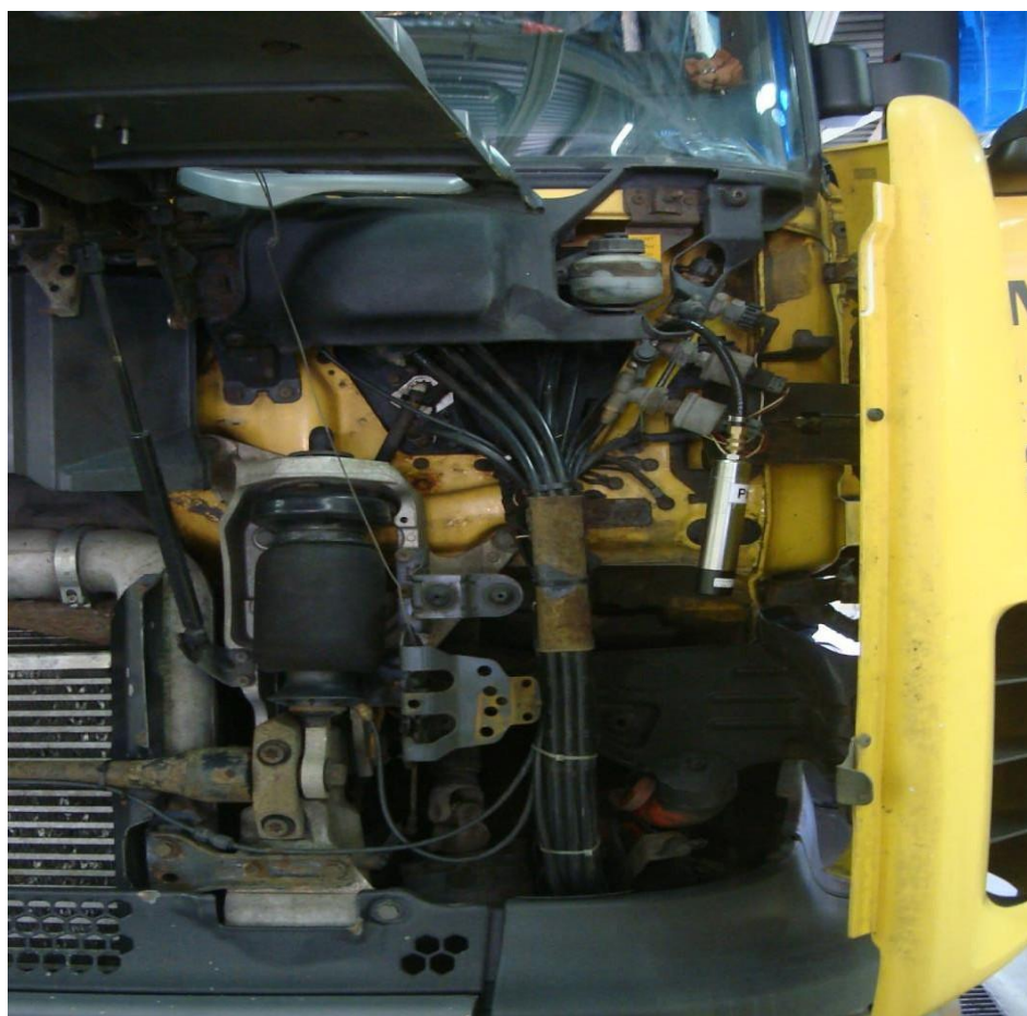
Рисунок 3.12 - Установка датчика тиску Pm на вихід з компресора тягача Scania R 114 LA 4x2 LA 340 SLA
