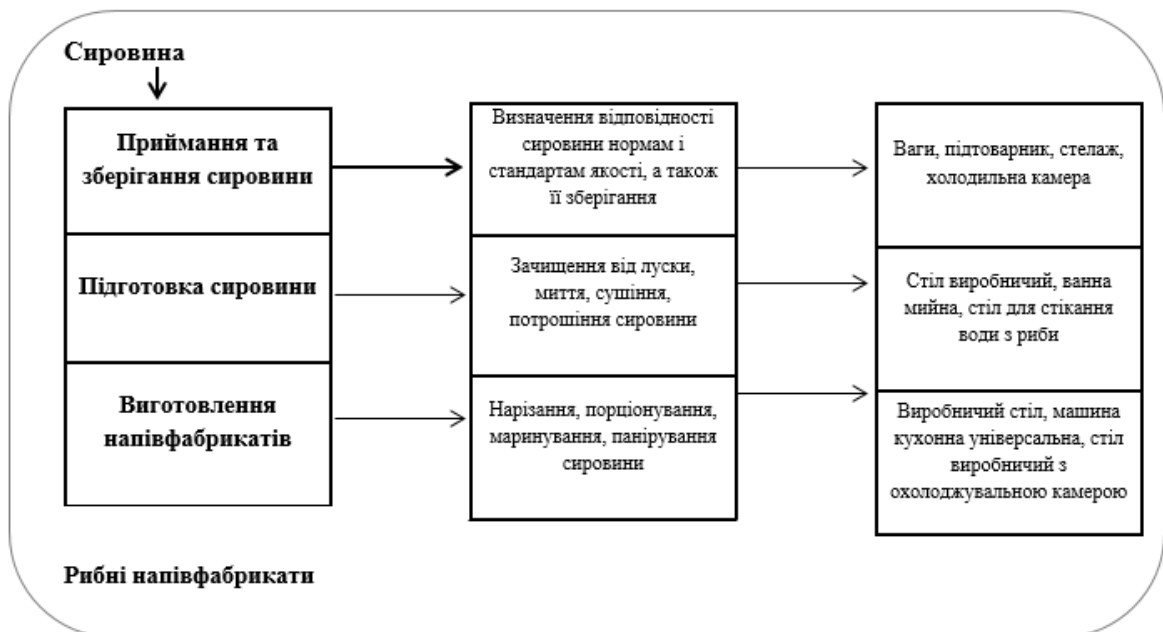
Рис. 3.7 – Виробничий процес рибного цеху ресторану «Coral Reef»
