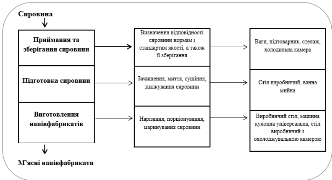
Рис. 3.6 – Виробничий процес м'ясного цеху ресторану «Coral Reef»
