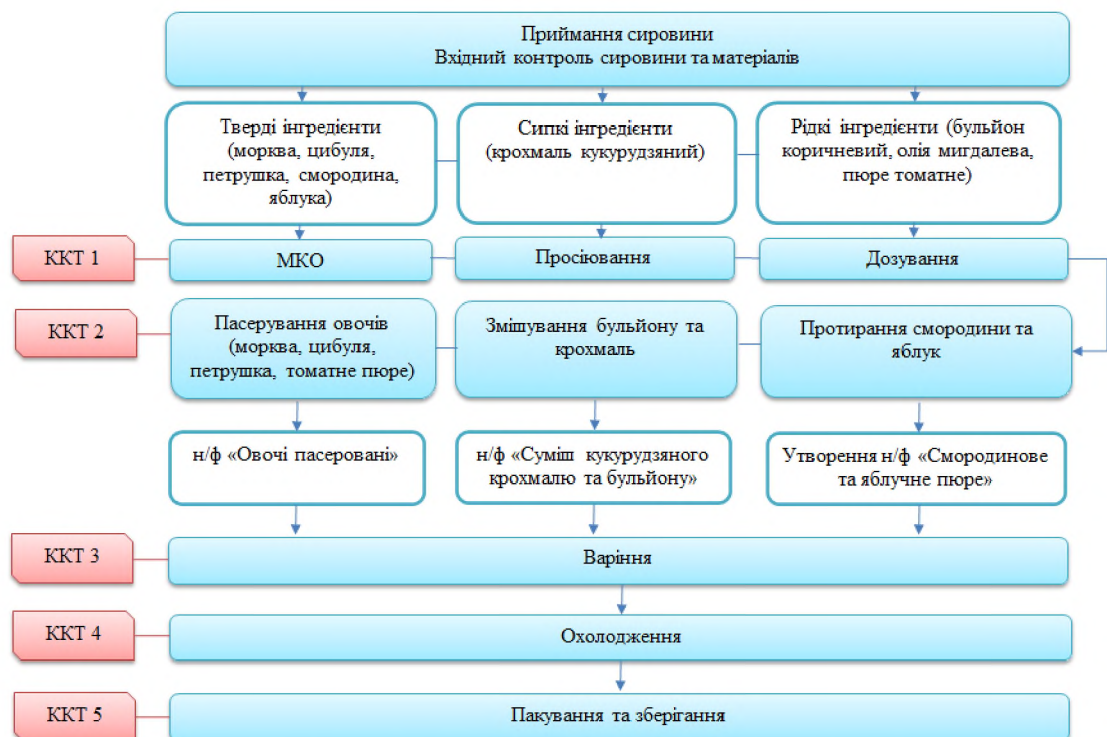
Рис. 3.2 Блок-схема виробництва нового виробу із визначенням КТК
