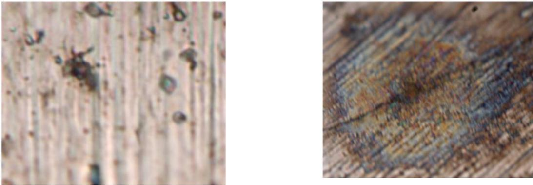
Рис. 7.65. Микрофотографии образцов с содержанием оксида иттрия 0,1 вес% (слева) и 1 вес.% (справа). x100
