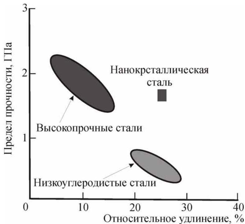
Рис. 1.7. Блок-схема изменения механических свойств различных материалов [11]
