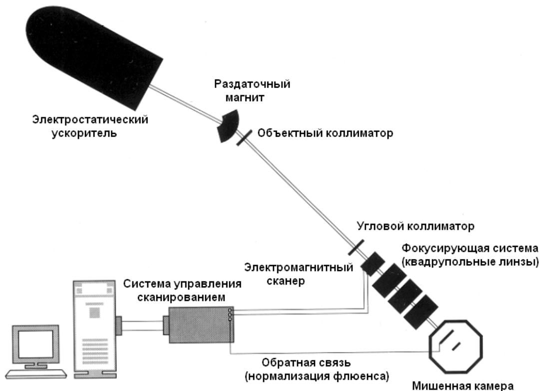
Рис. 6.29. Схема формирования сфокусированного пучка легких ионов средних энергий в ядерном сканирующем микрозонде для целей технологии p-beam writing
